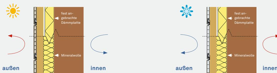
Gedämmte und hinterlüftete Fassadenverkleidung, die im Sommer die Wärme abschirmt und die Kühle im Inneren hält
